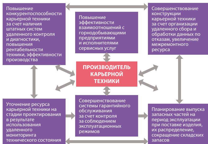
Рис. 5. Преимущества беспроводной системы вибромониторинга для производителя карьерных самосвалов. Источник: [8]
