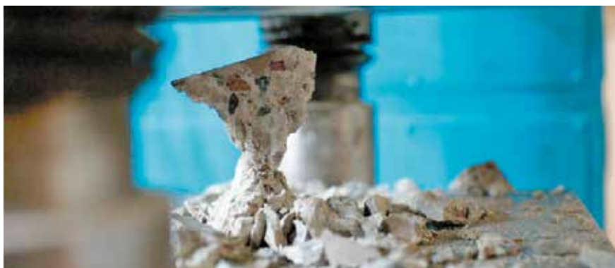
Рис. 2. Вид образцов из серобетона после испытания при одноосном кратковременном сжатии
