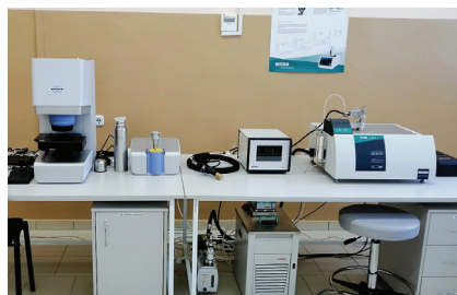
Интегрированный ИК-Фурье микроскоп, включающий 2 модуля
