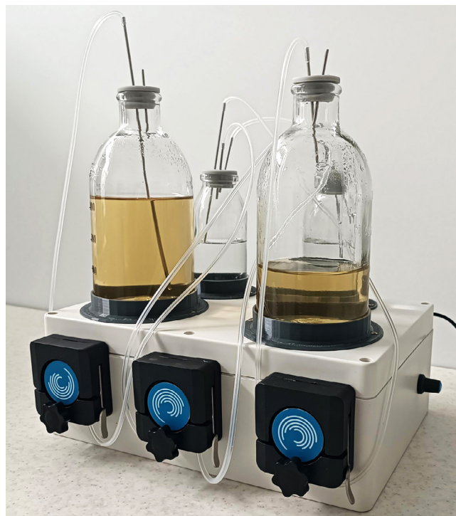
Рис. 1. Автоматический перфузируемый биореактор для фармакокинетического моделирования
