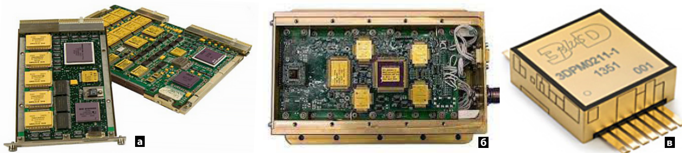
Рис. 2. Материнские платы компьютеров компании «Baе Systems» (а) и блок аппаратуры КА, содержащий радиационно-стойкую электронную память (технология RAD-PAK) (б), корпус ИМС компании «3D Plus» (технология WALOPACK) (в)
