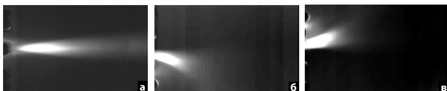
Рис. 6. Кинокадры компрессионного плазменного потока: а – истекающий прямо компрессионный плазменный поток; б и в – поток, отклоненный в разные стороны
