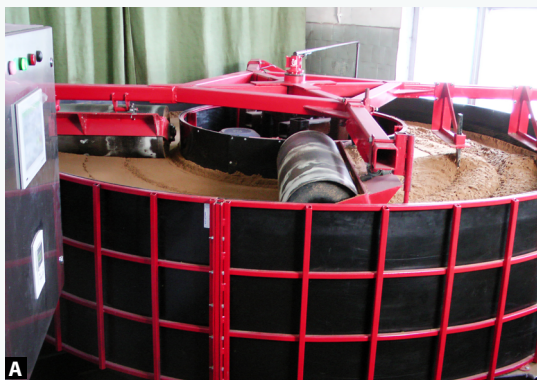
Рис. 1. Экспериментальные стенды: А – кругового типа для испытаний почвообрабатывающих рабочих органов; Б – для исследования фрикционных свойств почвы
