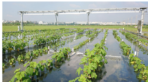
Рельсовые рамные мультисенсорные платформы для полевых условий и больших групп растений
