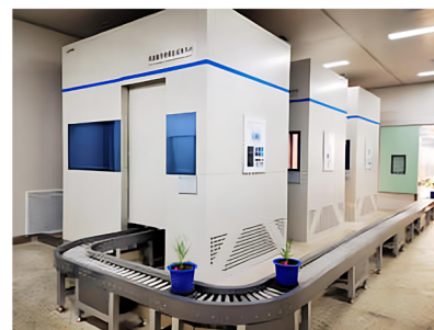
Конвейерные платформы для больших групп растений с множеством сенсоров
