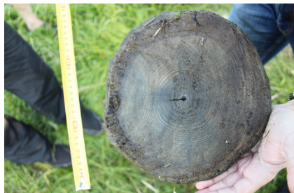
Мал. 6. Паля падводнай канструкцыі ў воз. Дзерба. Спіл №1 у ніжняй частцы
