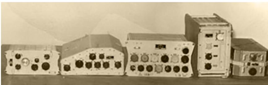
Рис. 6. Управляющая цифровая вычислительная машина
