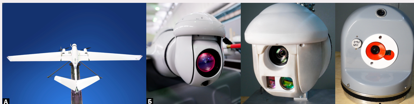
Рис. 7. Многофункциональный БАК: а – БЛА; б – варианты оптико-электронных систем для БЛА
