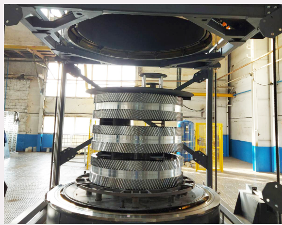
«Завод БКУ» – филиал ООО «Уралмаш НГО Холдинг», г. Тюмень (оборудование используется с 2021 г.), обработка вал-шестерен (в вакуумной камере шахтного типа) и зубчатых колес для насосов буровых установок (в камере колпакового типа).
