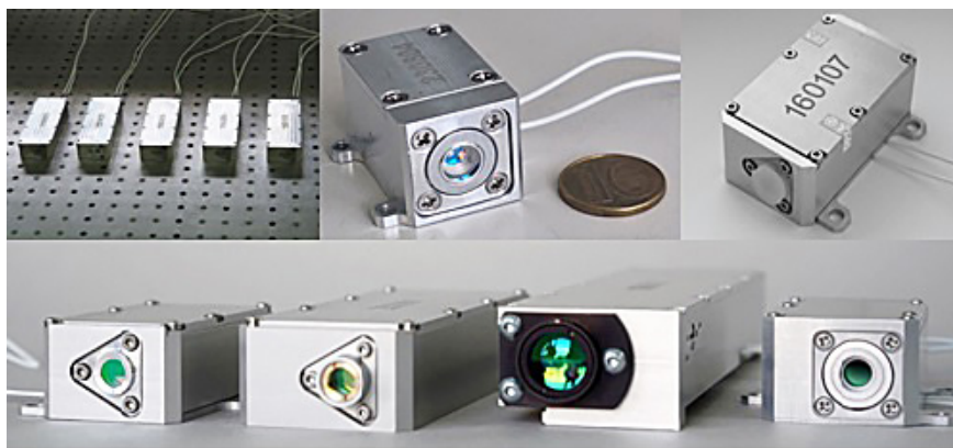
Рис. 1. Серия иттербий-эрбиевых лазеров с поперечной диодной накачкой и пассивной модуляцией добротности: длина волны излучения 1535 нм; энергия выходных импульсов 1–8 мДж; частота следования импульсов – до 20 Гц; длительность импульсов излучения – менее 16 нс; диаметр выходного пучка менее 1 мм; параметр качества пучка – менее 1,3 (интервал рабочих температур от –40 до +70 °С)
