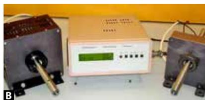
Рис. 8. Базовые модели приборов магнитного неразрушающего контроля структуры изделий массового производства: «МАКСИ-У» (А), «МАКСИ-П» (Б), «МАКСИ-Р» (В)
