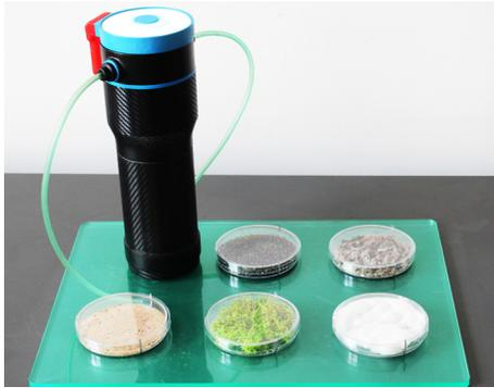
Рис. 14. Макет походного водного фильтра с картриджами из природных материалов (мох, кварцевый песок, уголь), которые человек может пополнять самостоятельно. Электронная часть и приложение демонстрируют степень загрязненности воды. Led-светильник имеет функцию обеззараживания, Д.А. Шематович
