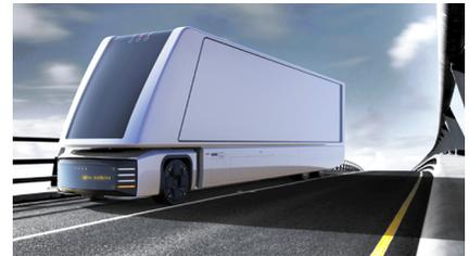
Рис. 17. Дизайн магистрального беспилотного электрического грузового автомобиля, призванного снизить стоимость доставки благодаря сокращению затрат на заработную плату, В.Е. Мартыненко
