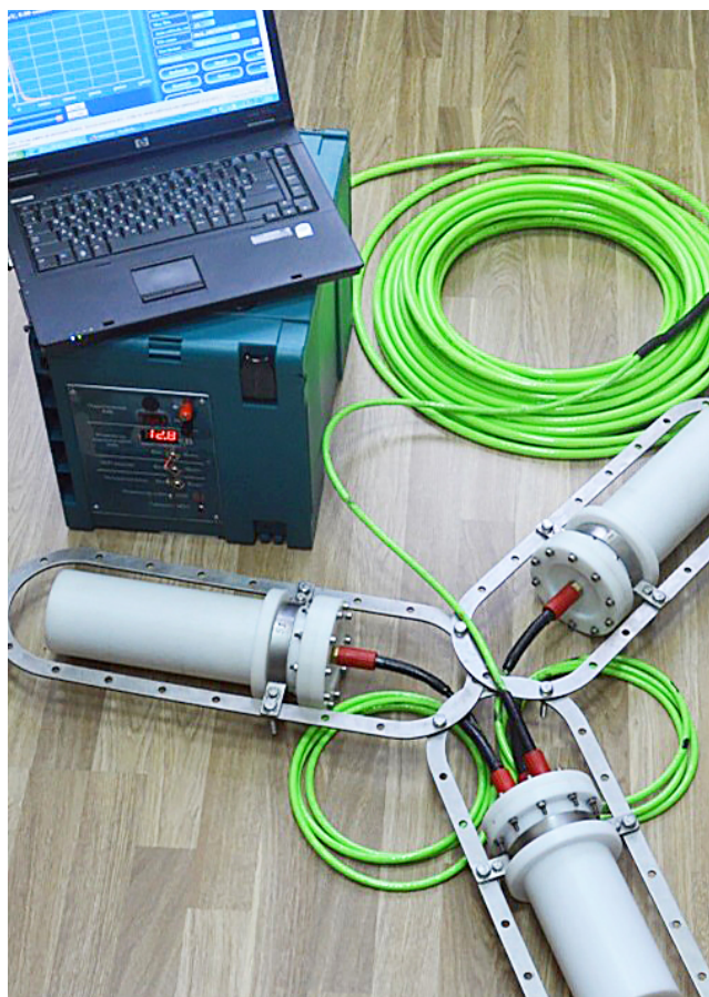
Рис. 4. Двухкристальный гамма-спектрометр высокого разрешения на базе детекторов со сцинтиллятором SrI 2 (Eu), созданный в Институте физики НАН Беларуси
