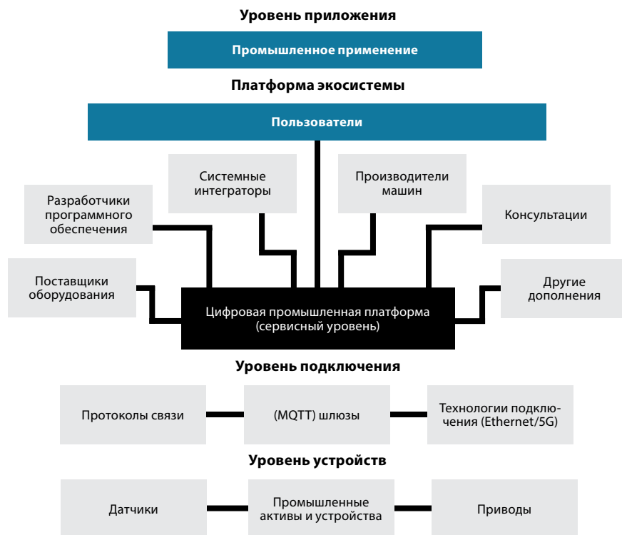
Рис. 1. Архитектура цифровых промышленных платформ [4]
