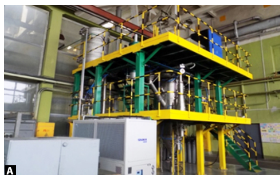
Рис. 2. Установка распыления и порошки, полученные по технологии VIGA в Институте порошковой металлургии имени академика О.В. Романа: а) установка вакуумной индукционной плавки и распыления расплава инертным газом; б) морфология поверхности распыленных порошков никелевого жаропрочного сплава, полученных по технологии VIGA в Институте порошковой металлургии им. академика О.В. Романа
