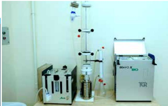
Тестер эффективности бактериальной фильтрации TCR KIT BF
