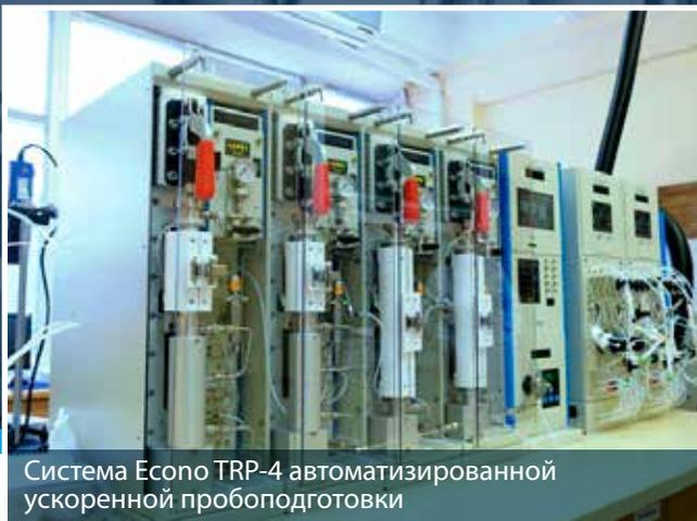
Система Econo TRP-4 автоматизированной ускоренной пробоподготовки
