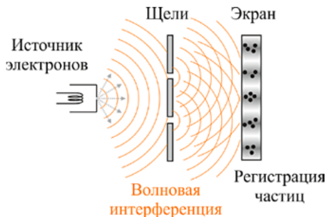
Рис. 3. Схема экспериментов по наблюдению интерференции электронов. Одиночные частицы – электроны – проходят через щели и регистрируются на экране. Каждая из них детектируется в некоторой вполне определенной точке, то есть проявляет привычные для частиц свойства. Однако рисунок, возникающий на экране при накоплении большого количества зарегистрированных электронов, имеет вид, характерный для интерферирующих волн. Такой эффект сохраняется, даже если электроны летят по одному (следующий вылетает не раньше, чем произошло детектирование предыдущего). Это позволяет предположить, что способность интерферировать, «чувствуя» одновременно обе щели, – не коллективный эффект (как в случае волн на поверхности водоема или звуковых волн), а свойство каждой отдельной частицы
