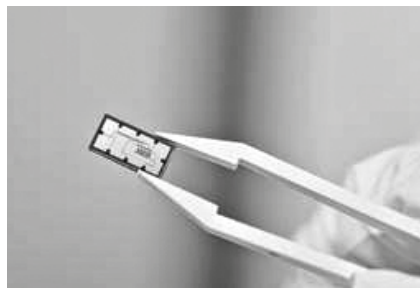
Рис. 9. Пятикубитный квантовый симулятор (МИСиС, ФГУП «ВНИИА им. Н.Л. Духова»)
