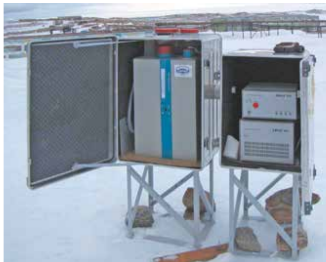
Рис. 3. Мобильный двухволновой лидар в Антарктиде
