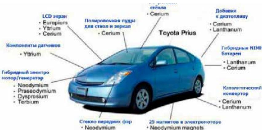
Рис. 2. Узлы в автомобиле, содержащие РЗМ
