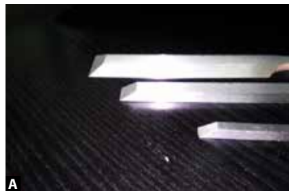
Биметаллические образцы изделий с самозатачивающейся режущей кромкой: а) номенклатура изделий по типоразмеру, б) структура режущей кромки
