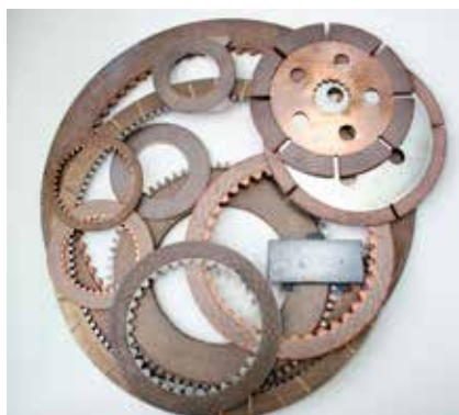
Рис. 1. Фрикционные диски из новых спеченных композиционных материалов
