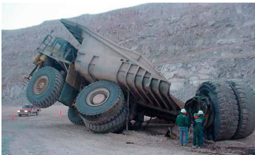
Рис. 1. Пример разрушенных деталей с неоптимальным слоем упрочнения, не выдержавших циклические нагрузки
