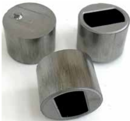
Рис. 3. Заготовки порошковых деталей «Поршень СТ.078000.163.ПЗ» компрессора холодильников «Атлант»
