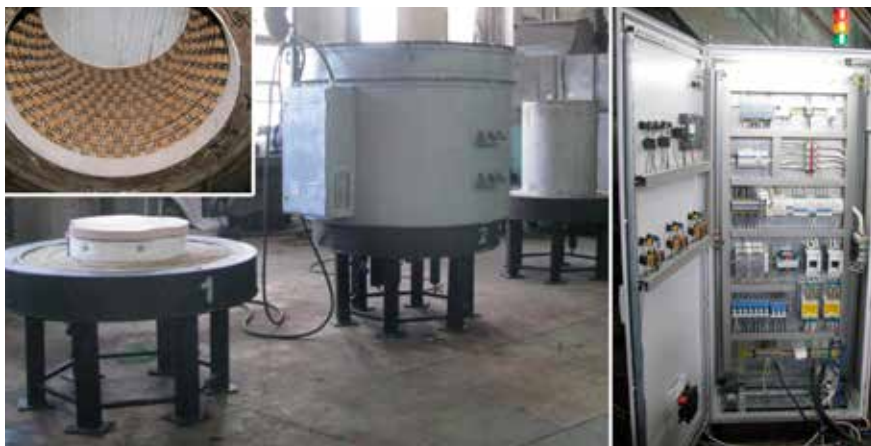
Рис. 2. Колпаковая трехстендовая печь для спекания фрикционных дисков в защитной атмосфере, разработанная и изготовленная в ИТМО
