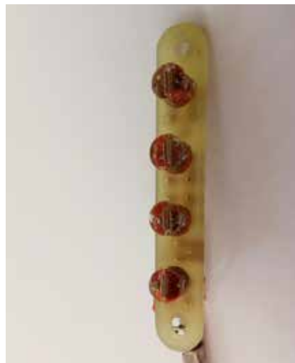
Рис. 6. Датчик контроля дефектности круглого стального проката
