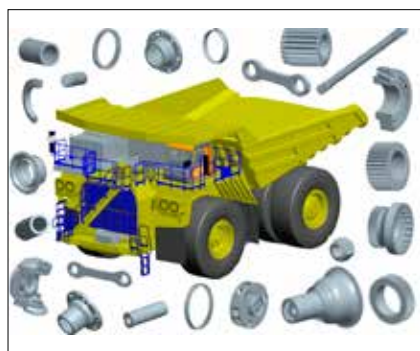
Рис. 7. Номенклатура деталей подвески БЕЛАЗ, обрабатываемых на комплексе
