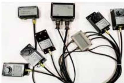
Рис. 1. Система мониторинга метана в критичных точках автомобиля
