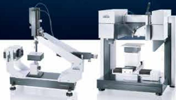
Измерители краевого угла смачивания
