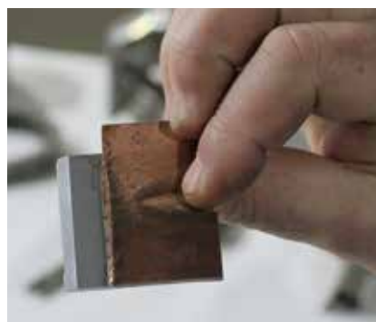
Образец соединения двух разных металлов (сталь и медь)
