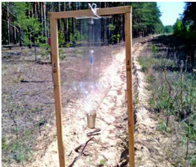
Рис. 3. Феромонная ловушка для контроля численности вершинного короеда в сосновом насаждении в Гомельском опытном лесхозе
