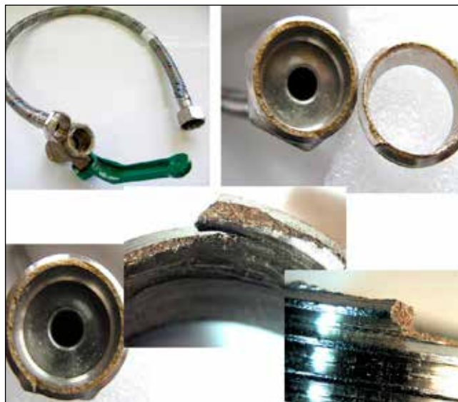
Рис. 6. Общий вид и морфология поверхности излома гибкой подводки
