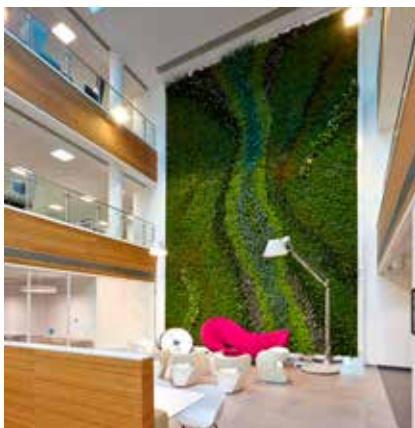
Рис. 2. Фитостена площадью 93 м 2 в офисе British Gas (Оксфорд) действует как акустический буфер и естественный фильтр для улучшения качества воздуха. Фото из портфолио компании Biotecture ( https://www.biotecture.uk.com )
