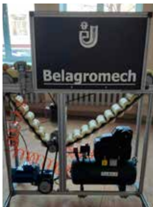
Рис. 2. Прототип системы распознавания некондиционных клубней картофеля
