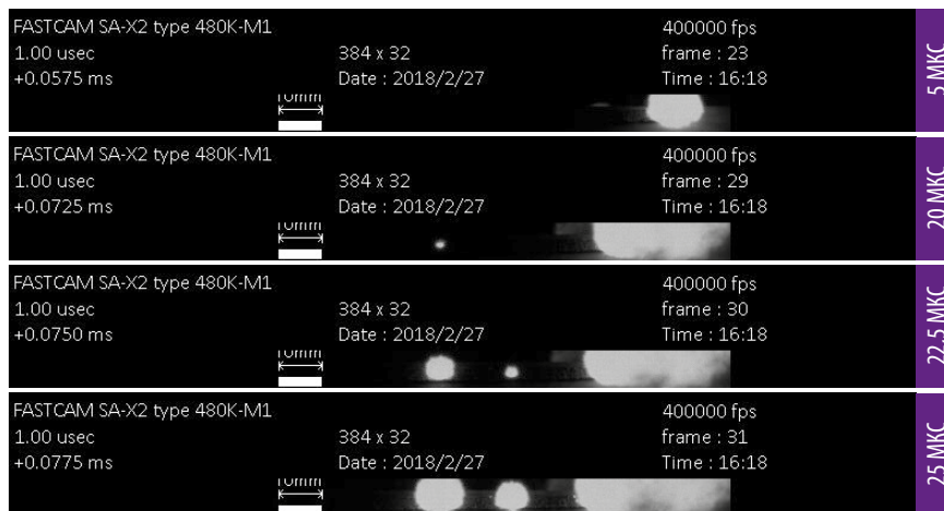
Рис. 7. Распространение горения (справа налево) по ПК-композиту с толщиной пористого слоя 58 мкм и пористостью 0,73 с формированием предвестников
