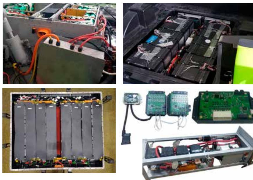
Рис. 7. Тяговые аккумуляторные батареи и их компоненты разработки Объединенного института машиностроения НАН Беларуси
