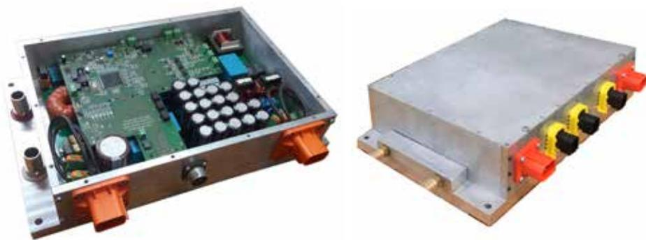
Рис. 8. Бортовое зарядное устройство разработки Объединенного института машиностроения НАН Беларуси
