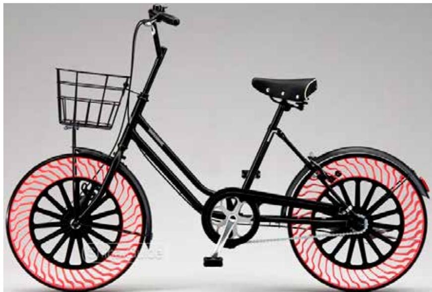
Рис. 8. Велосипед с безвоздушными шинами Bridgestone [7]
