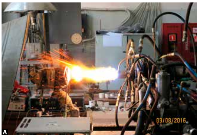
Рис. 1. Высокоэнергетическая плазмотронная установка ЭДПГ: А – экспериментальный стенд; Б – воздействие двухфазного плазменного потока на образец тепловой защиты
