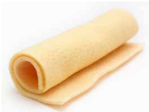
Волокнистый ионит в виде нетканого иглопробивного полотна
