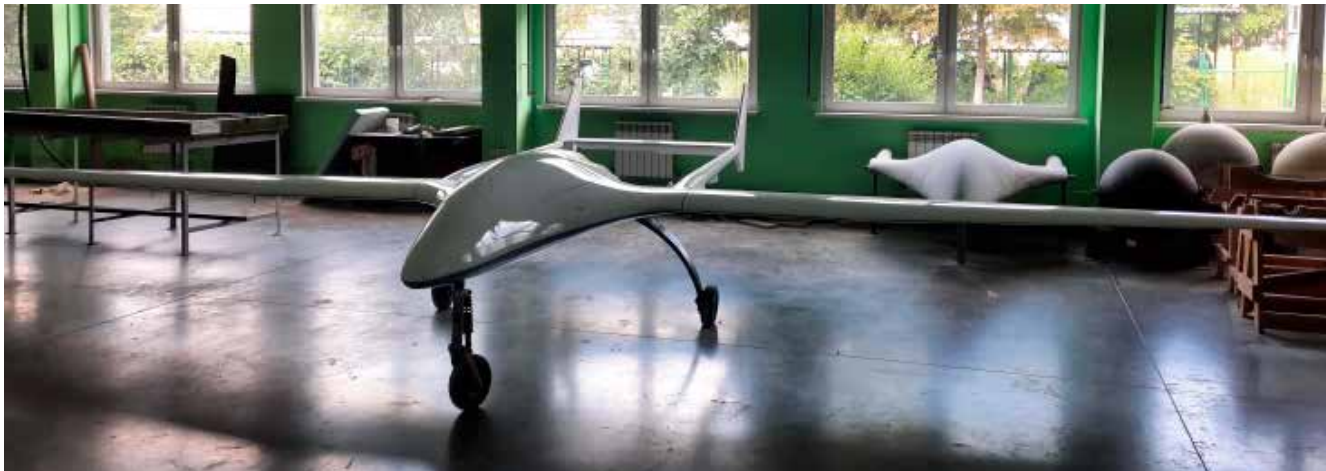
Рис. 12. Новый БЛА «Буревестник 9» с размахом крыла 9 м
