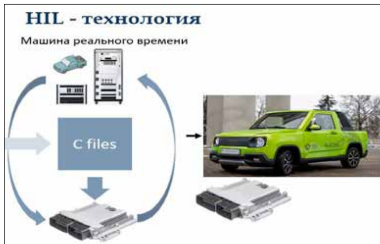
Рис. 1. Пример применения модельно-ориентированного подхода с использованием HiL-технологии при разработке машиностроительной продукции
