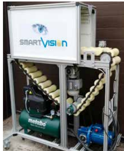
Рис. 9. Макетный образец автоматической сортировальной машины
