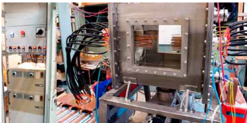
Рис. 2. Формирование квазистационарных высокоэнергетических плазменных образований при столкновении компрессионных плазменных потоков
