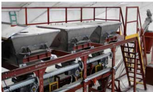
Система питателей-дозаторов и смесительного устройства технологической линии по производству комплексных гранулированных органоминеральных удобрений пролонгированного действия
