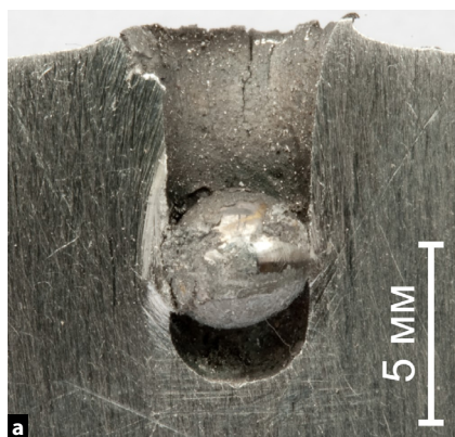
Рис. 6. Фотография среза кратера, образовавшегося после удара в мишенях из алюминиевого сплава Д16Т:
