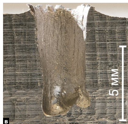
Рис. 6. Фотография среза кратера, образовавшегося после удара в мишенях из алюминиевого сплава Д16Т:
