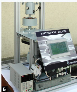
Рис. 1. Экспериментальные стенды: А – кругового типа для испытаний почвообрабатывающих рабочих органов; Б – для исследования фрикционных свойств почвы
