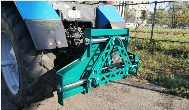
Рис. 2. Автоматическая управляемая навесная система
