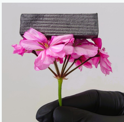
Рис. 3. Образец легковесной графитовой пены, полученной методом реструктурирования графита
