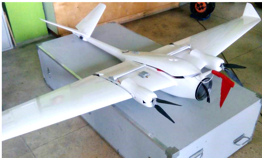
Рис. 2. Общий вид планера БВП на основе малоразмерного БЛА «Бусел-М» (без ЦН)
