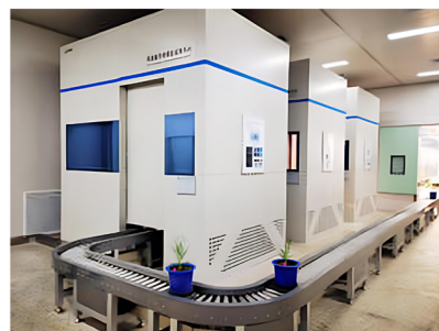
Конвейерные платформы для больших групп растений с множеством сенсоров
