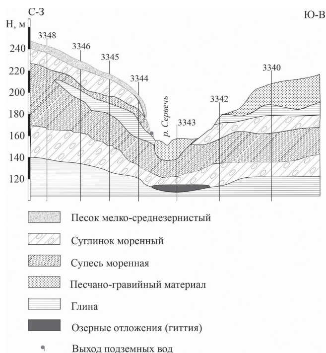
Рис. 18. Геологический профиль через долину р. Сервечь
