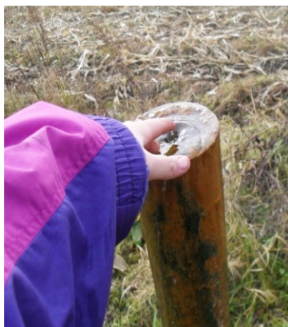
Рис. 3. Наблюдательная скважина 104 Хоновского гидрогеологического поста (самоизлив)
