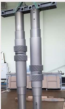
«Завод БКУ» – филиал ООО «Уралмаш НГО Холдинг», г. Тюмень (оборудование используется с 2021 г.), обработка вал-шестерен (в вакуумной камере шахтного типа) и зубчатых колес для насосов буровых установок (в камере колпакового типа).
