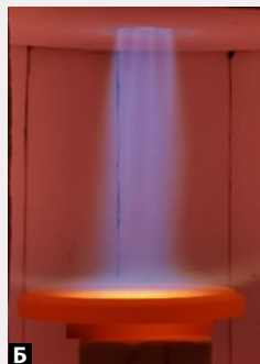
Рис. 14. Технология получения высокочистого аморфного кварцевого стекла: а – «Цифровой двойник» высокотемпературной печи для реализации технологии; б – экспериментальное оборудование; в – полученный образец
