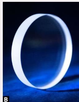
Рис. 14. Технология получения высокочистого аморфного кварцевого стекла: а – «Цифровой двойник» высокотемпературной печи для реализации технологии; б – экспериментальное оборудование; в – полученный образец
