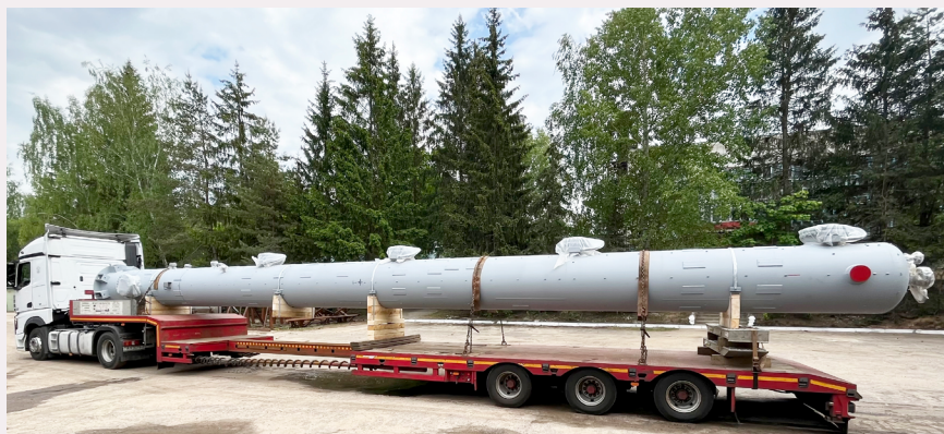
Рис. 19. Абсорбер К-205 (изготовлено для ОАО «Мозырский НПЗ»)
