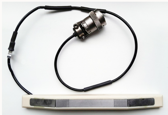
Дифференциальный датчик магнитного поля для контроля дефектности круглого стального проката
