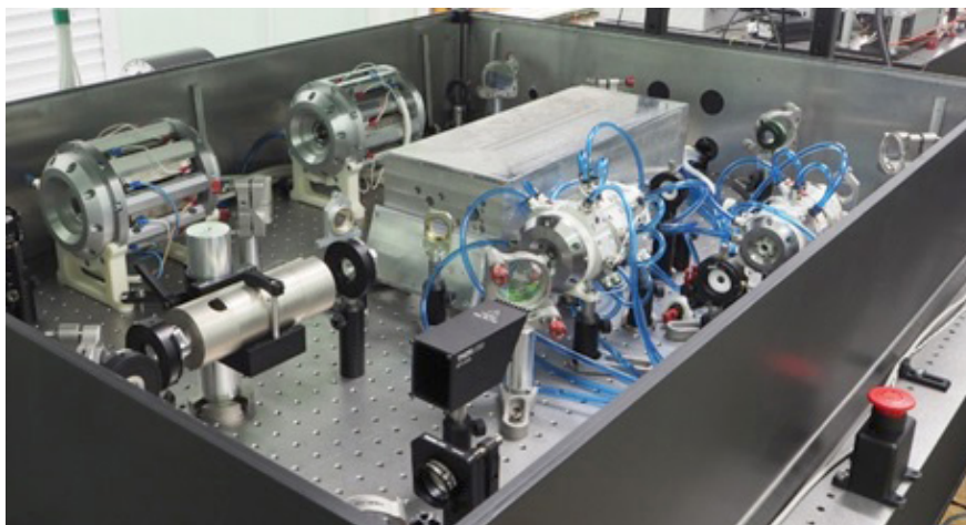
Рис. 4. Твердотельный лазер с диодной накачкой и энергией в импульсе до 5 Дж. Частота следования импульсов до 20 Гц, длительность импульсов 13,5 \pm 0,5 нс
