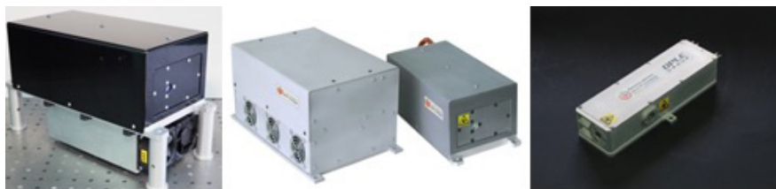
Рис. 2. Серия параметрических генераторов света на основе задающих Nd: YAG-лазеров с диодной накачкой: длина волны излучения 1571 нм; энергия выходных импульсов 15–50 мДж; частота следования импульсов – до 30 Гц; длительность импульсов излучения – менее 10 нс; диаметр выходного пучка менее 5 мм; параметр качества пучка – менее 6 (интервал рабочих температур от –40 до +55 °С)
