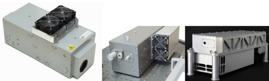
Рис. 3. Серия многоволновых Nd: YAG-лазерных систем с диодной накачкой для лидарных и спектроскопических исследований: длина волны излучения 1,064 нм, 532 нм, 355 нм, 266 нм; энергия выходных импульсов на основной частоте до 400 мДж; частота следования импульсов – до 30 Гц; длительность импульсов излучения – менее 10 нс; диаметр выходного пучка менее 6 мм; параметр качества пучка – менее 6 (интервал рабочих температур от –40 до +55 °С)
