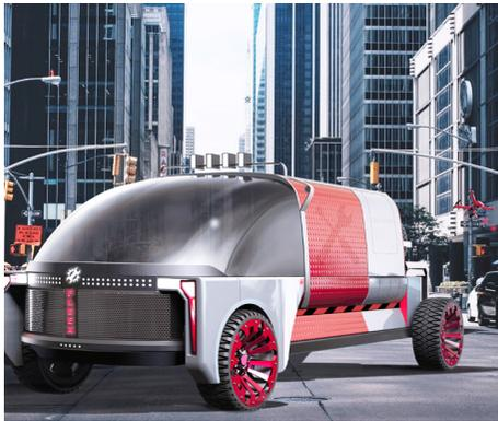
Рис. 15. Дизайн мобильного многофункционального СТО с элементами аддитивных технологий – функцией 3D-печати и объемом сканирования поломок для ремонта и обслуживания электромобилей сетевых фирм по доставке товаров. Дрон выявляет поломку до приезда мобильной СТО, которая печатает детали по ходу движения к ТС, В.В. Другелите
