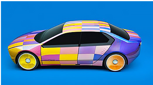
Концепт-кар BMW i Vision Dee (выставка CES 2023) использует технологию E-Ink для изменения цветов и добавления узоров с помощью различных электрических зарядов
