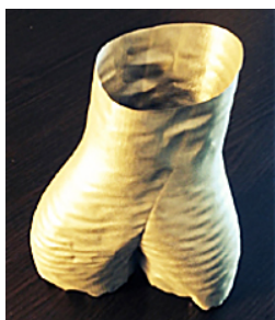
Рис. 5. Коробление поверхности из-за слишком малой толщины стенки (собственность компании Renishaw)
