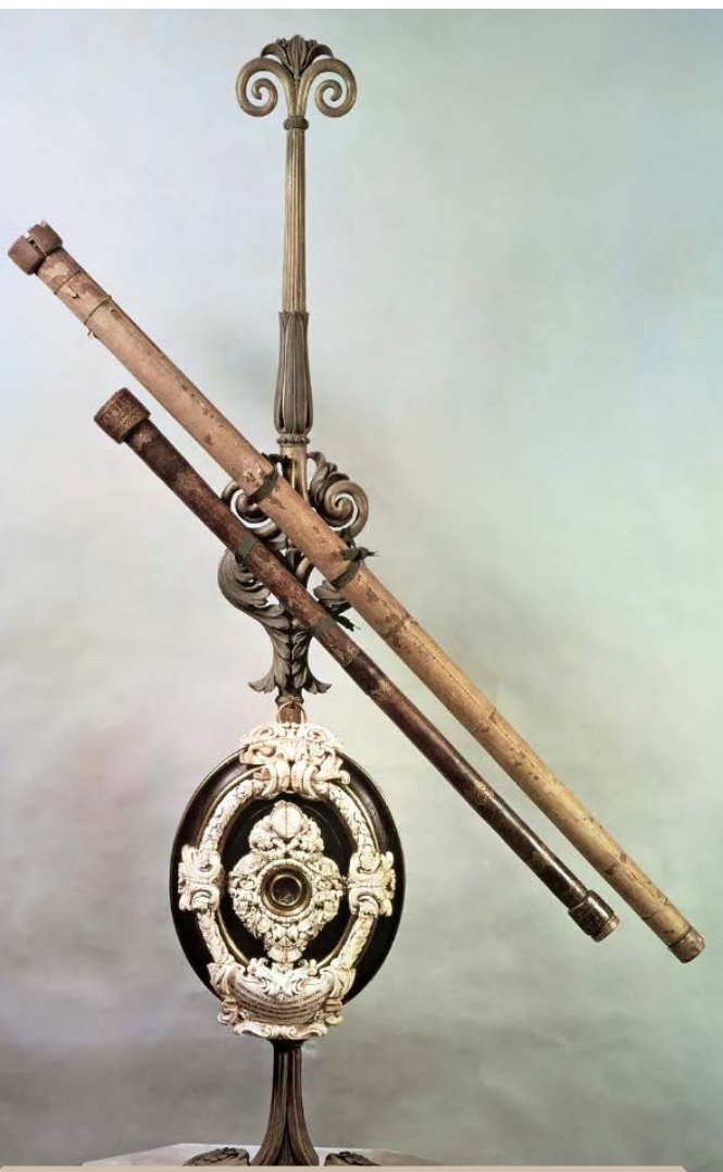
Рис. 3. Телескоп Галилео Галилея «Perspicillum» с диаметром объектива 4,5 см и увеличением 32х (доступном в современной любительской цифровой фотокамере), позволивший ему совершить революционные для своего времени открытия
