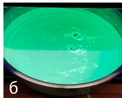
Рис. 2. Частицы сцинтиллятора Li 2 CaSiO 4 :Eu (а) и его же слой после упорядочения гранулометрического состава под облучением УФ-лампы (б)
