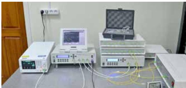
Рис. 3. Национальный эталон единицы поляризационной модовой дисперсии в оптическом волокне НЭ РБ 54-19
