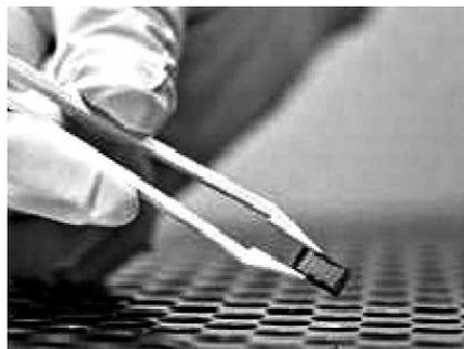
Рис. 5. Квантовый чип с высокодобротными СВЧ-резонаторами
