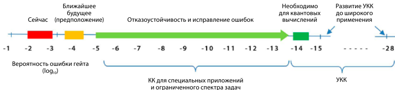
Рисунок. Прогнозируемая эволюция создания УКК как функция достигаемой пороговой вероятности ошибки гейта
