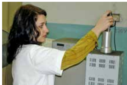
Рис. 10. Прибор «МАКСИ-У» с преобразователем прибора «МАКСИ-Д» в ЦЗЛ филиала ММЗ в г. Столбцы и ответственные болты, возвращенные в производство после неразрушающего контроля
