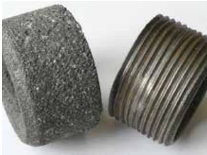
Рис. 6. Внешний вид отливки и готового изделия «ниппель 1¼» и зависимости отношения W остаточной намагниченности M_d отливок «ниппель 1¼» из белого чугуна к M_d этих отливок из ферритных ковкого (1) и серого (2) чугунов (магнитные параметры – средние значения из таблицы 1) от напряженности H_e намагничивающего поля. Расчет по методике [28]. 1', 2' – F после намагничивания отливок в поле H_e = 1000 кА/м
