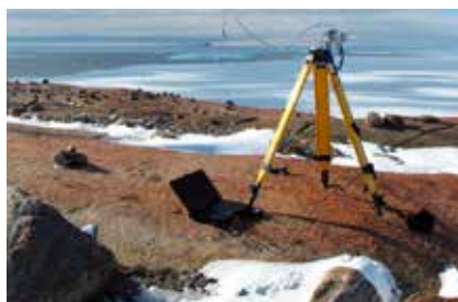
Рис. 5. Спектральный альбедометр, измеряющий отражательную способность снежной поверхности и скальных пород
