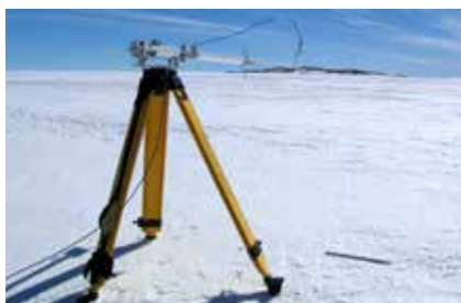
Рис. 5. Спектральный альбедометр, измеряющий отражательную способность снежной поверхности и скальных пород
